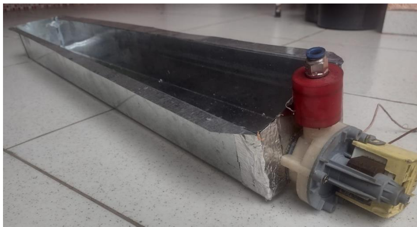
Figura 3: Reservatório com bomba d'água. Fonte: autoria própria.
