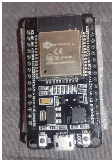
Figura 5: Microcontrolador esp32. Fonte: autoria própria.
