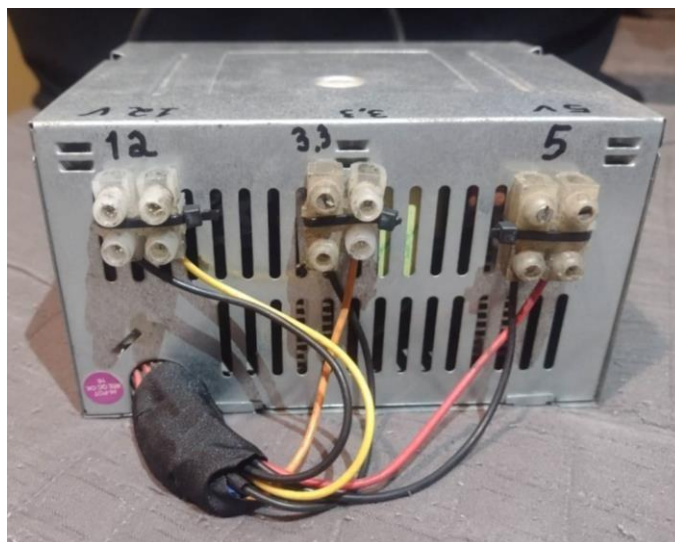
Figura 6: Fonte ATX com separação de voltagem. Fonte: autoria própria.
