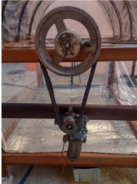
Figura 4: Motor 12 V com polia. Fonte: autoria própria.
